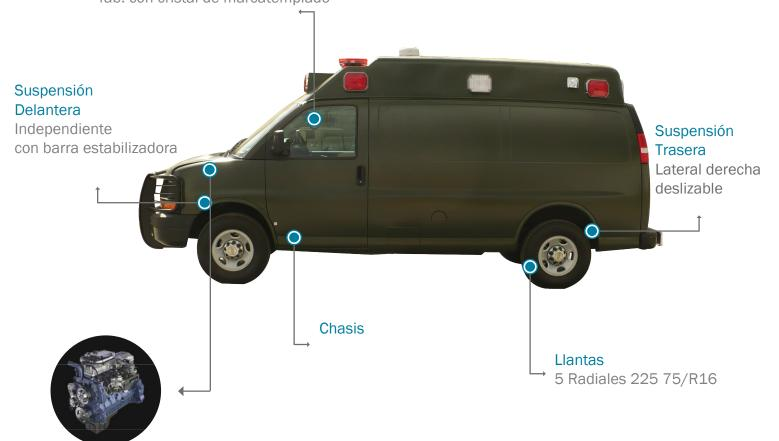
Modelo: 4.6 lts, inyección electrónica secuencia multipunto
